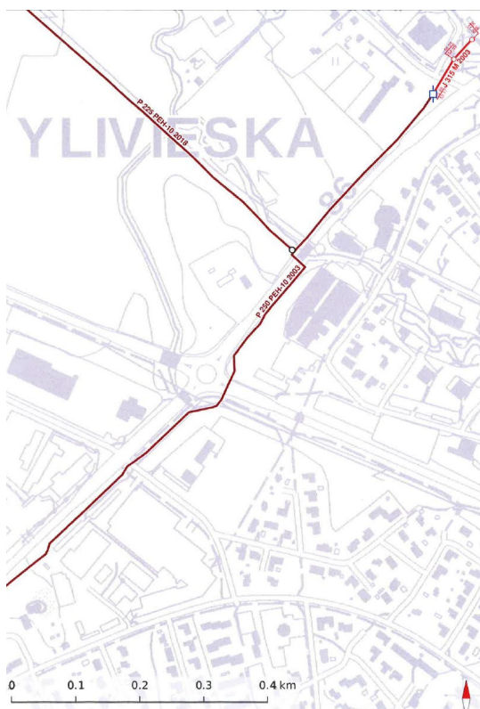
Kuva: Vesikolmio OY:n siirtoviemärin linjaus. Johtaluevaraus pääosin liikennealueella ja osin korttelin 1-65 alueella.
