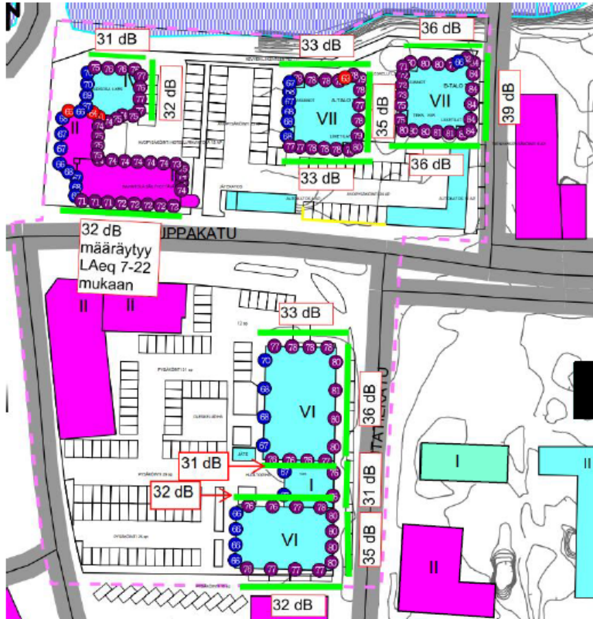
Kuva 6.1. Ehdotetut julkisivujen äänieristyksen lukuarvot dB
