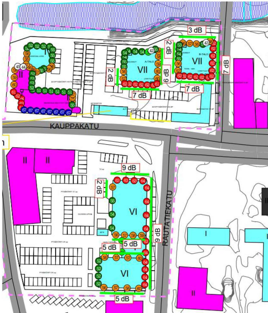
Kuva 6.1. Parvekelasituksilta edellytetty äänitasoero päiväajan ohjearvoon 55 dB pääsemiseksi.
