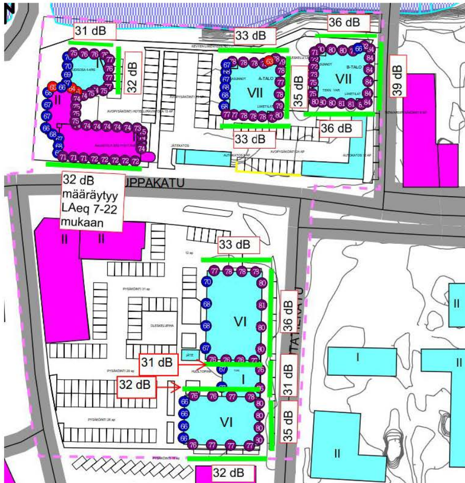
Kuva 6.2. Ehdotetut julkisivujen äänieristyksen lukuarvot dBA
