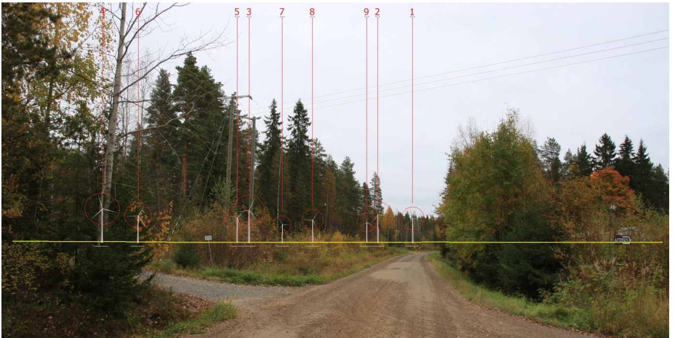
Kuva 51. Valokuvasevite kuvauspaikka 6. Näkymä Säilynperältä lähimpien asuinrakennusten luota "Säilyntie 209". Etäisyys lähimpään Urakkanevan voimalaan on noin 2,7 km. Voimalat jäävät katselupisteessä lähes kokonaisuudessa puuston peittoon yhden voimalan siipiä lukuun ottamatta.
