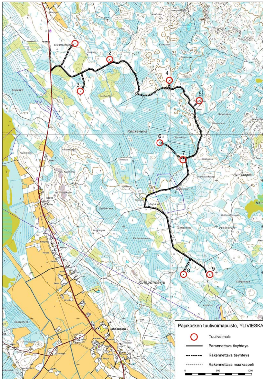
Kuva 2. Hankkeen alustava voimalasijoittelu, huoltotiestä ja sähkönsiirto.
