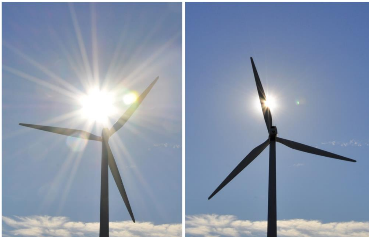
Kuva 6.79. Tuulivoimaloiden lavat aiheuttavat pyöriessään vilkkumista ja varjon välkkymistä aurinkoisella säällä
