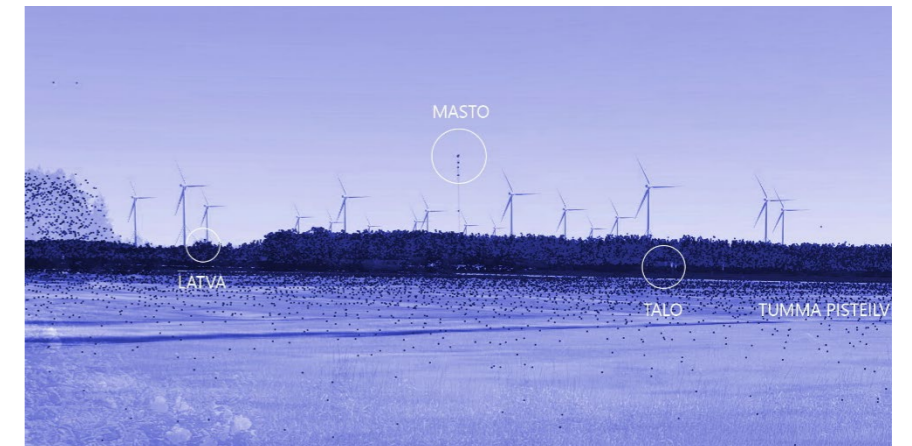
Kuva: esimerkki kiintopisteistä. Pistepilvi (tumma) asetuu valokuvan puuston ja maston kanssa samalle korkeusasemalle. Pistepilven kuvaama puusto perustuu laserkeilaukseen MML:n lentokuvausvuotena. Horisontti ja rakennukset perustuvat MML:n korkeusmalliin ja maastotietokantaan.
