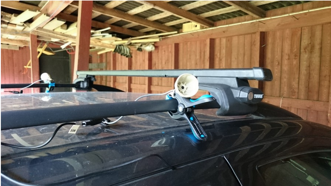
Kuva 3.3. Auton katolle sijoitetut mikrofonit tuulisuojineen.
